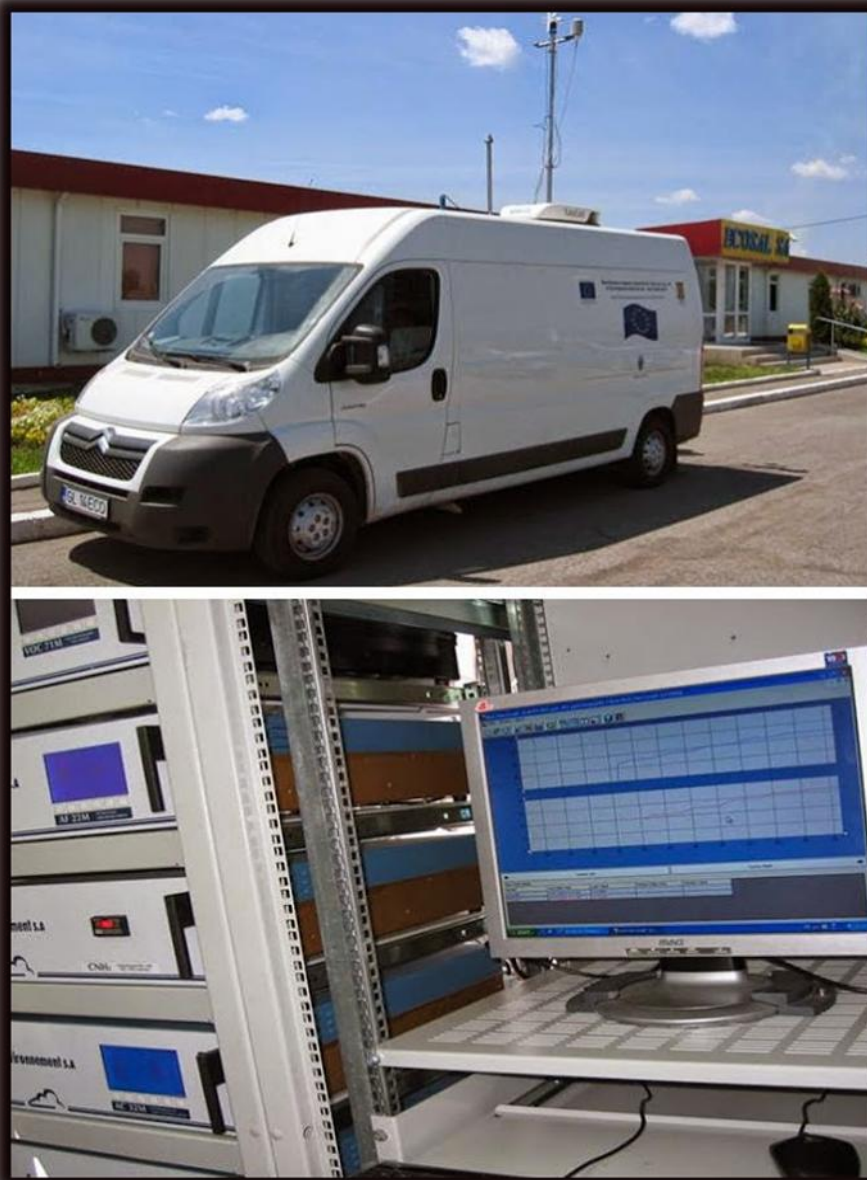
Figura 1: Laborator mobil pentru determinarea poluanților din aer Laboratorul mobil pentru determinarea poluanților atmosferici cuprinde [3]:
